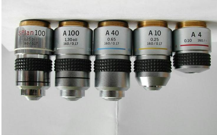
Zusammen mit der Maßzahl, dem Abbildungsmaßstab (hier im Bild 100, 40, 10 und 4 - das „:1“ wird weggelassen), sind noch weitere Gravuren auf dem Objektiv zu finden (hier: z.B. 0,10, 0,25, 0,65, 1,25 und 1,30). Das ist die berechnete **Numerischen Apertur (NA)**, das Mass für den Öffnungswinkels, der Auflösung des Objektivs (Vergleichbar mit der Lichtstärke von Objektiven in der Fotografie).
